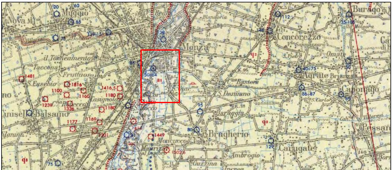
Figura 5.1 – Stralcio della Carta Geologica (scala 1:100.000) - Foglio 45 Milano. Geologia dell'area di studio: in azzurro chiaro ( a 1 ) alluvioni ghiaioso-sabbiose terrazzate: alluvium antico (Olocene); in giallo chiaro ( q 3 ) ghiaie sabbiose e sabbie con strato superficiale di alterazione limitato a 40 – 60 cm, costituenti il livello fondamentale della pianura: diluvium recente (Pleistocene); in giallo ( q 2 ) ghiaie sabbiose con strato di alterazione superficiale argilloso ocraceo (ferretto), potente fino a 200 – 250 cm: diluvium medio (Pleistocene). Nel riquadro rosso è indicata l'area in oggetto.
