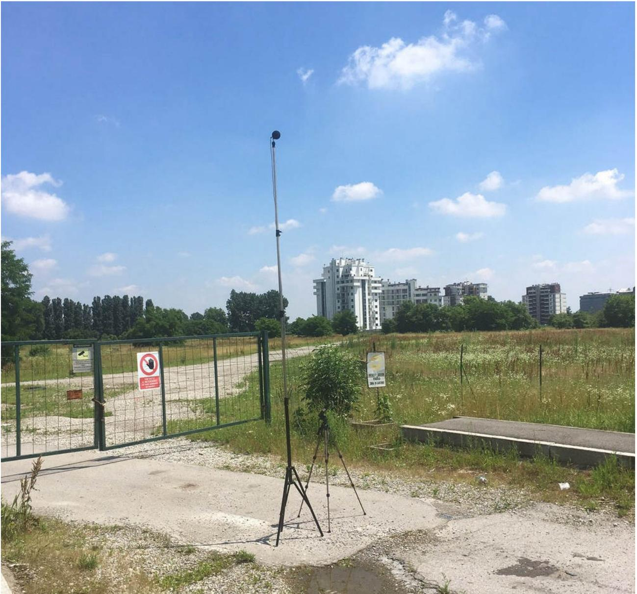
**Foto 1: Esempio di una postazione di misura.**
