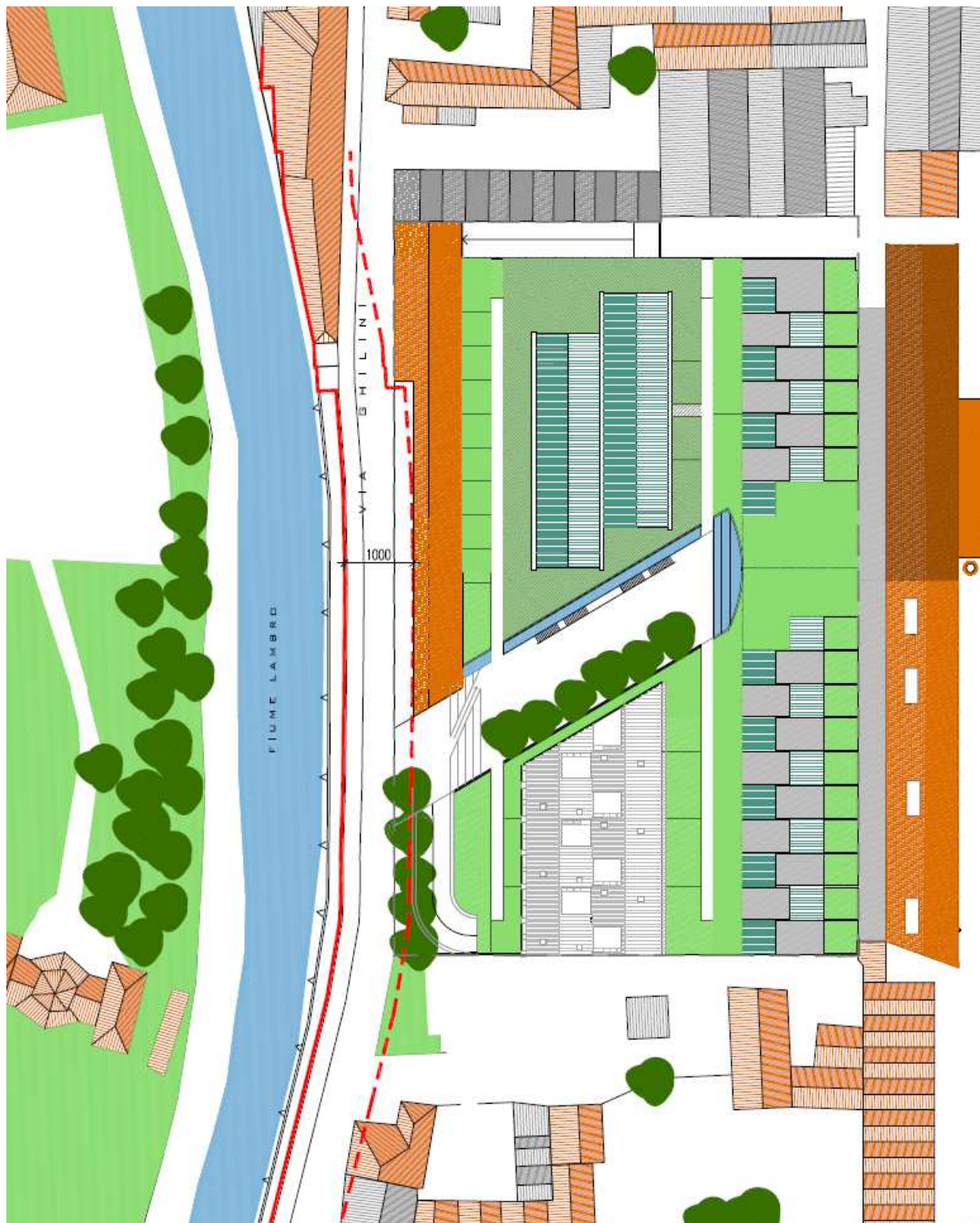
Figura 1.1 - Interventi in progetto e rispetto della fascia di rispetto del R.D. 523/1904 di 10 m (in rosso tratteggiata).
