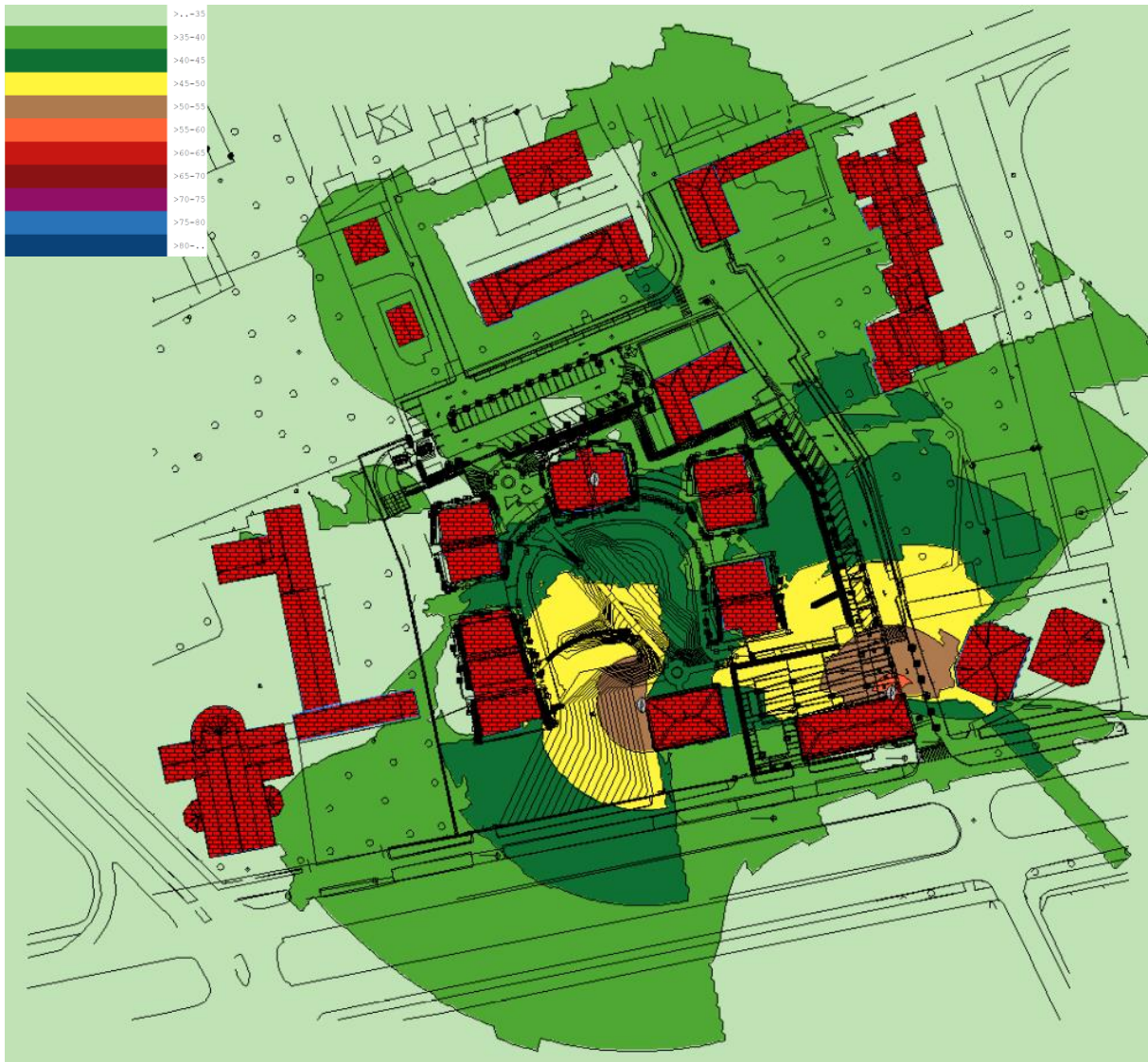
Figura 5-26: Scenario solo pompe di calore - Diurno a 12m dal suolo
