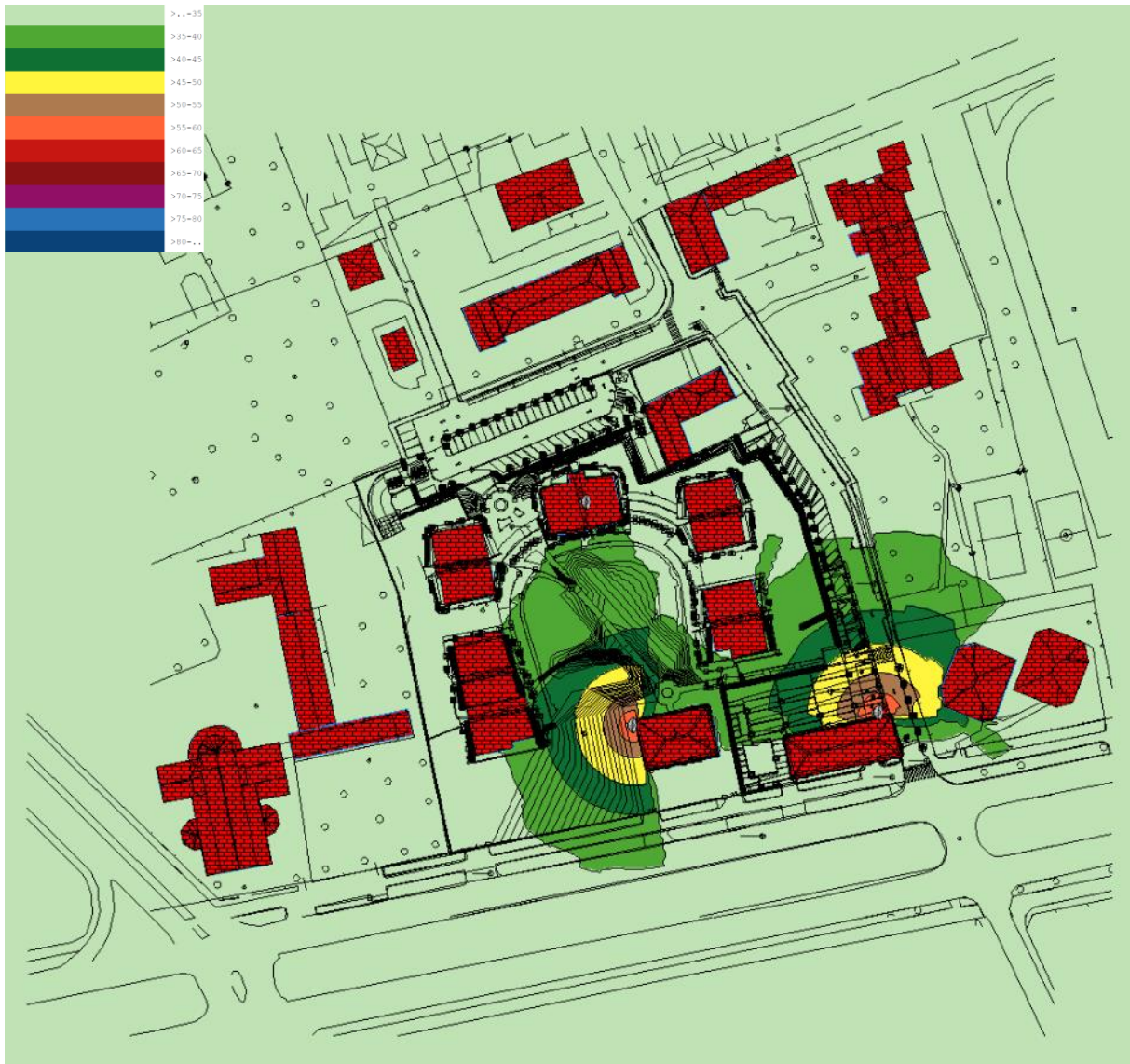
Figura 5-25: Scenario solo pompe di calore - Notturno a 3m dal suolo
