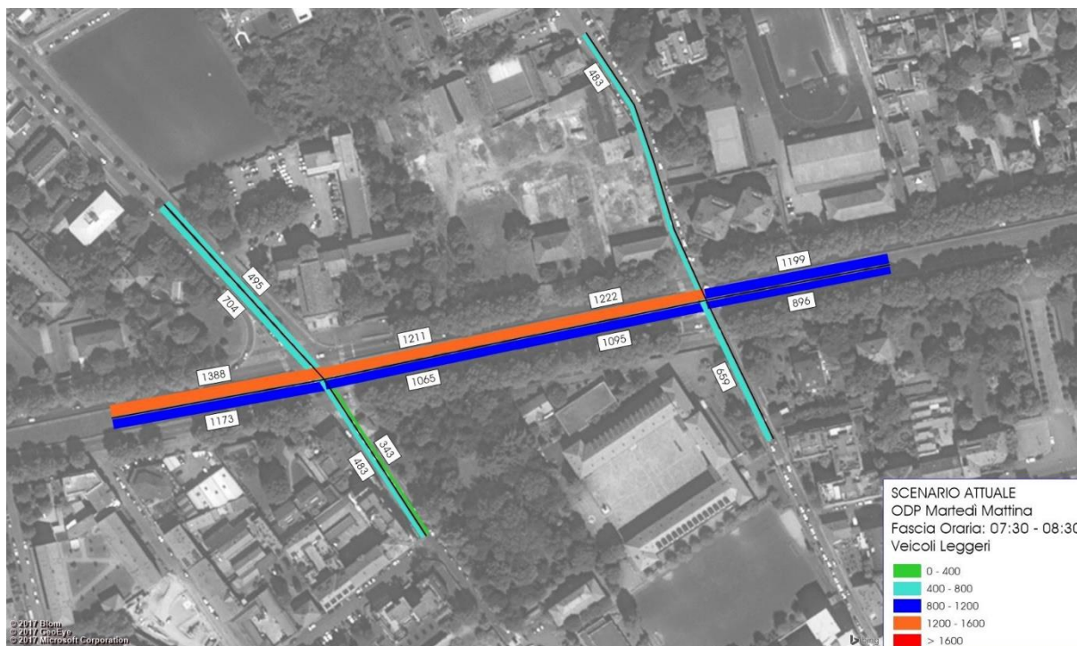
Figura 5-8: Estratto studio viabilistico TRM - Flussogramma scenario SdF, ora di punta mattino feriale - Veicoli leggeri
