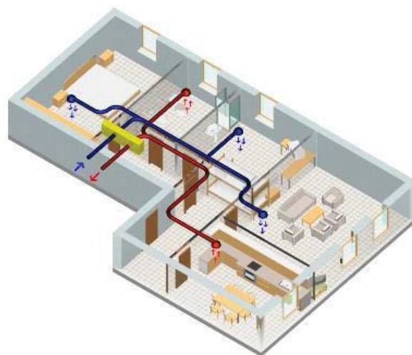
Fig. 18: Esempio tipico installazione impianto VMC
