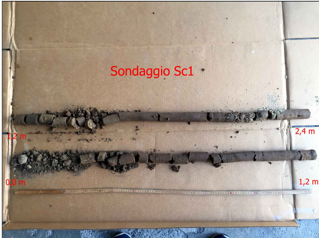
carote estratte dalla fustella per la caratterizzazione litostratigrafica
