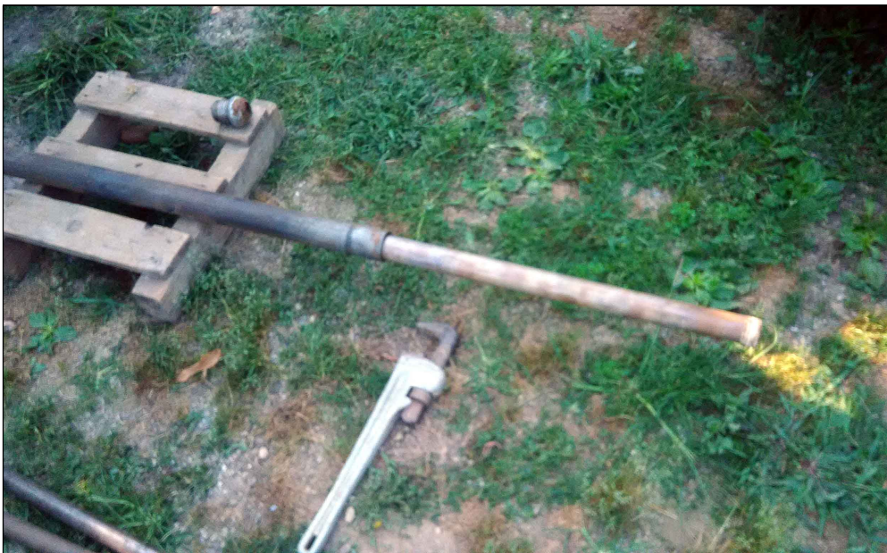
estrazione fustella durante il campionamento in sito
