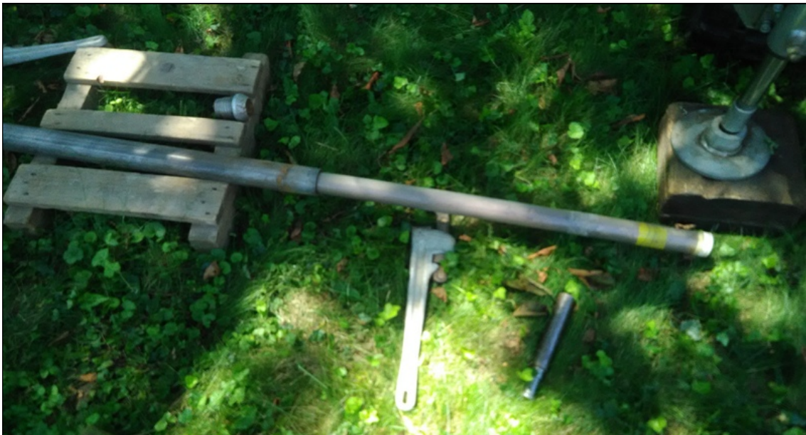
estrazione fustella durante il campionamento in sito
