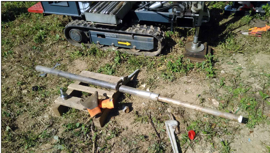
estrazione fustella durante il campionamento in sito
