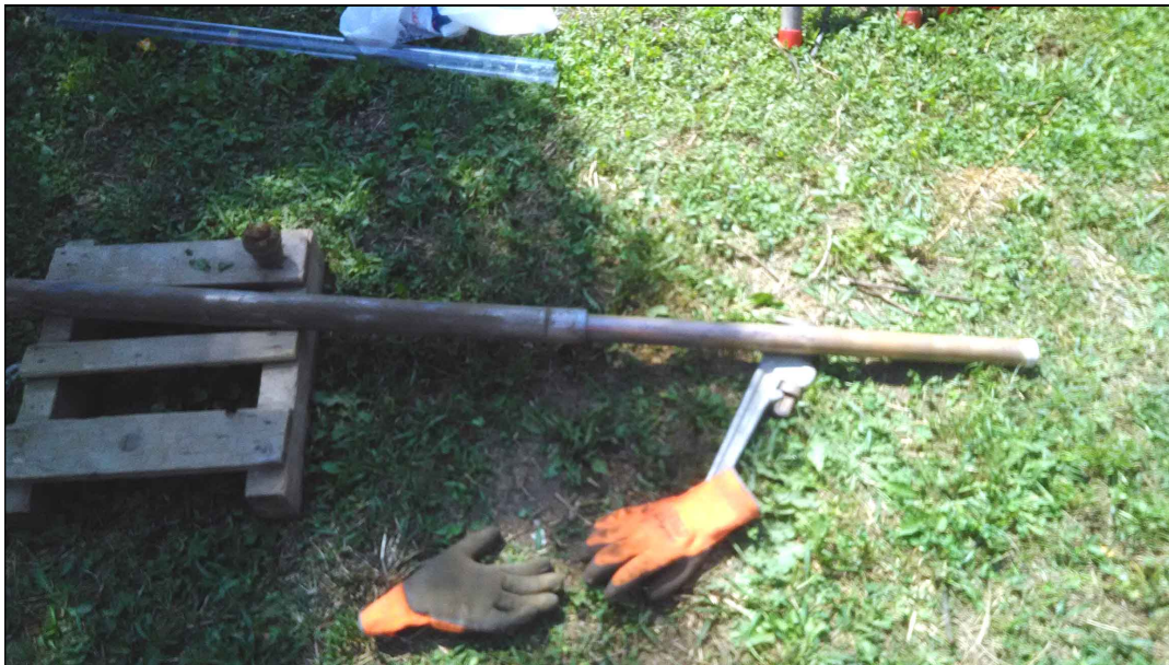
estrazione fustella durante il campionamento in sito
