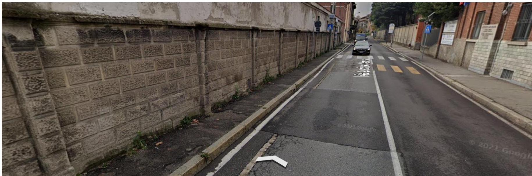
Sopra e sotto: tratto di via Manara aderente al lotto di intervento: manto di usura compromesso, calibro carreggiata e marciapiedi carenti
