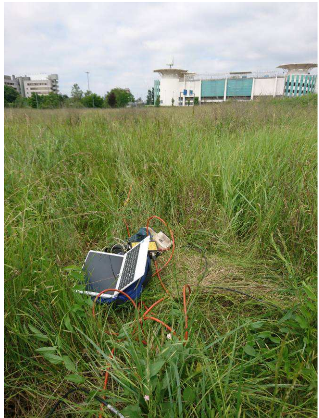
Stendimento sismico (lotto C-D)
